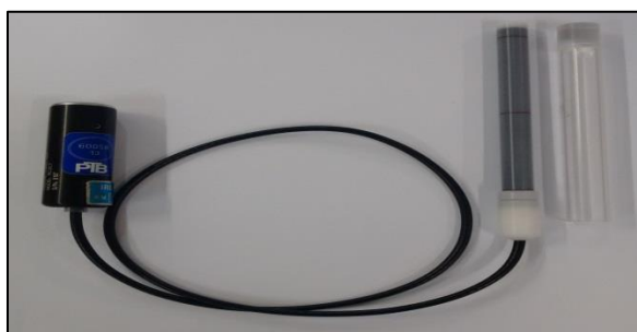
Figura 2: câmara de ionização tipo lápis, fabricada pela Radcal Corporation, modelo RC3CT.
