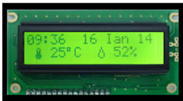
Figura 2: Display de cristal líquido.
