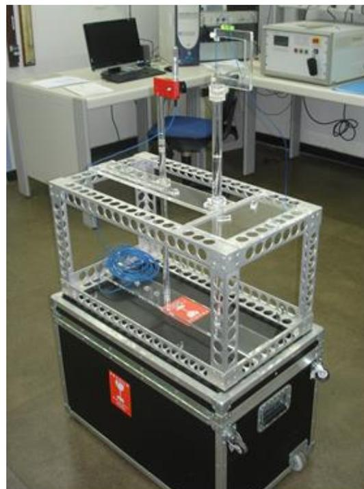
Figura 2 – Foto do sistema de posicionamento e suportes da câmara dedal e da fonte de  $^{192}\text{Ir}$  colocados sobre a mala de transporte para a realização das medições.
