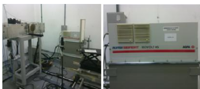
Figura 1 – Setup de calibração do sistema. Raios X industrial pantak Seifert dosímetros UNFORS e TLDs.
