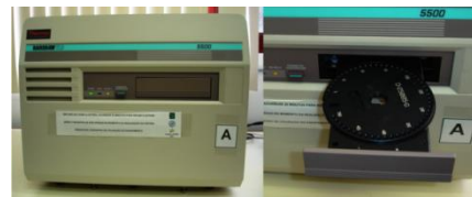
Figura 2 - Leitora Termoluminescente Harshaw 5500 Thermo Electron.
