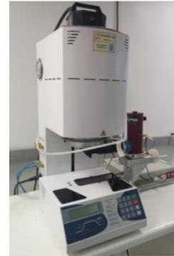
**Figure 3.** Diffusivimeter QuadruFlash 1200.
