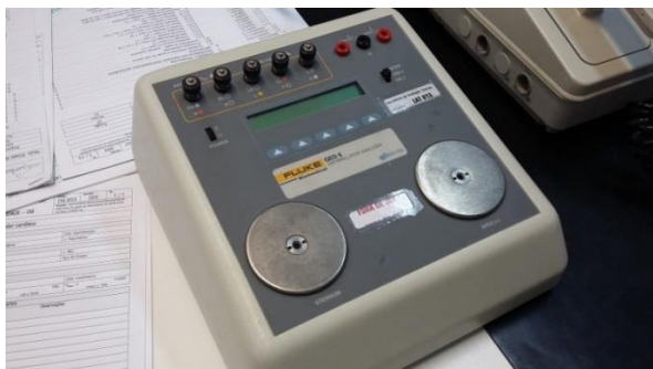
Figura 4. Analisador de desfibrilador presente no LAT
