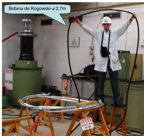
Figura 2 – Bobina de Rogowski com 8,5 metros de comprimento.
