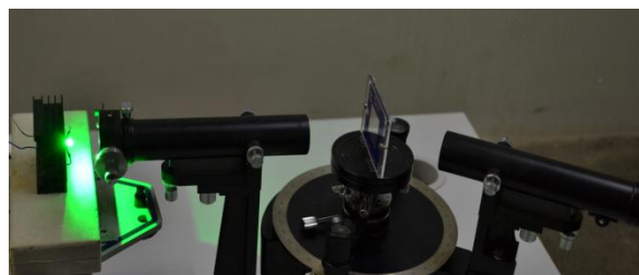
Figura 2: Goniômetro utilizado para determinação do comprimento de onda por grade de difração
